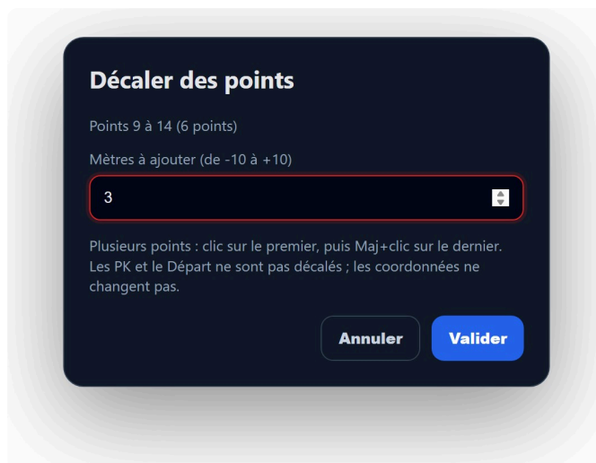
Figure 7 – Décaler les points 9 à 14 de +3 m.
