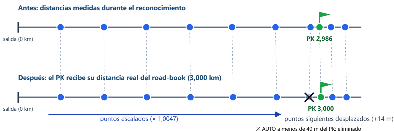
Figura 5 – Normalización con un PK: el PK medido a 2,986 km recibe su distancia real, 3,000 km.
