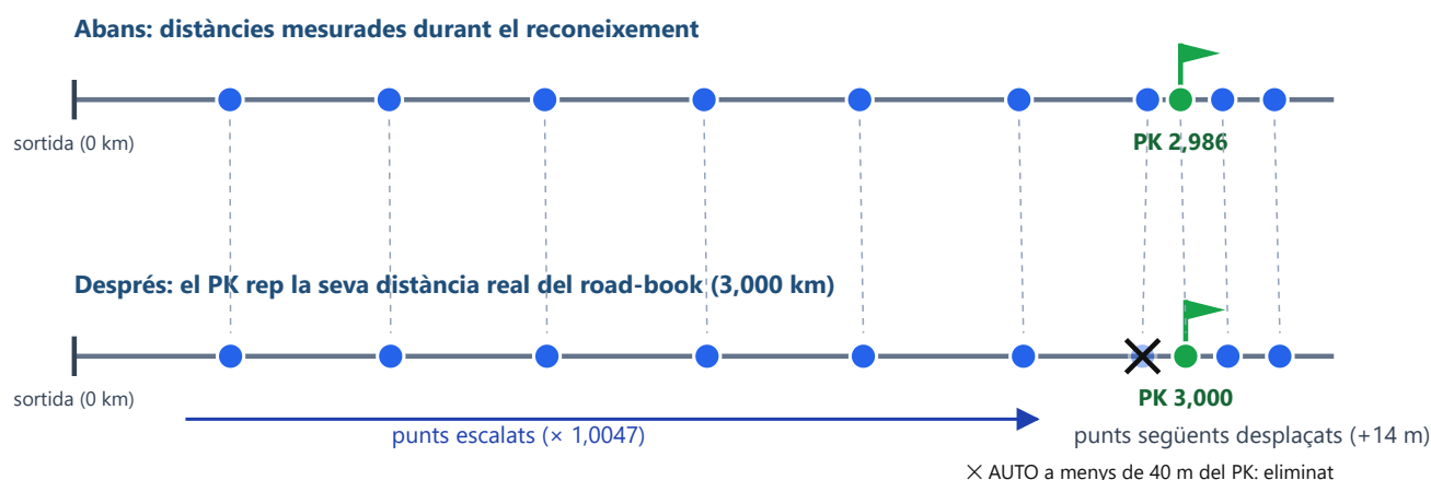
Figura 5 – Normalització sobre un PK: el PK mesurat a 2,986 km rep la seva distància real, 3,000 km.
